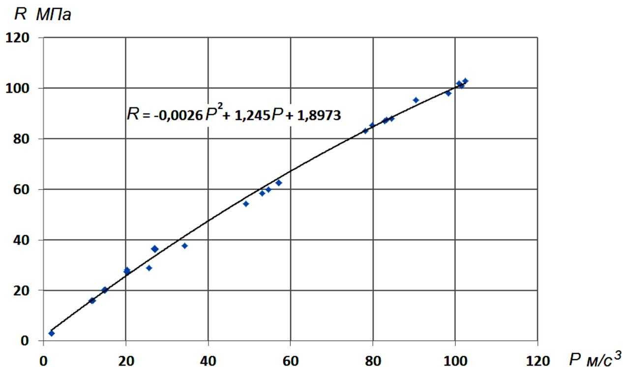
Рисунок 2 - Построение градуировочной зависимости между параметром  $P$  и прочностью бетона  $R$  с помощью полинома второго порядка
