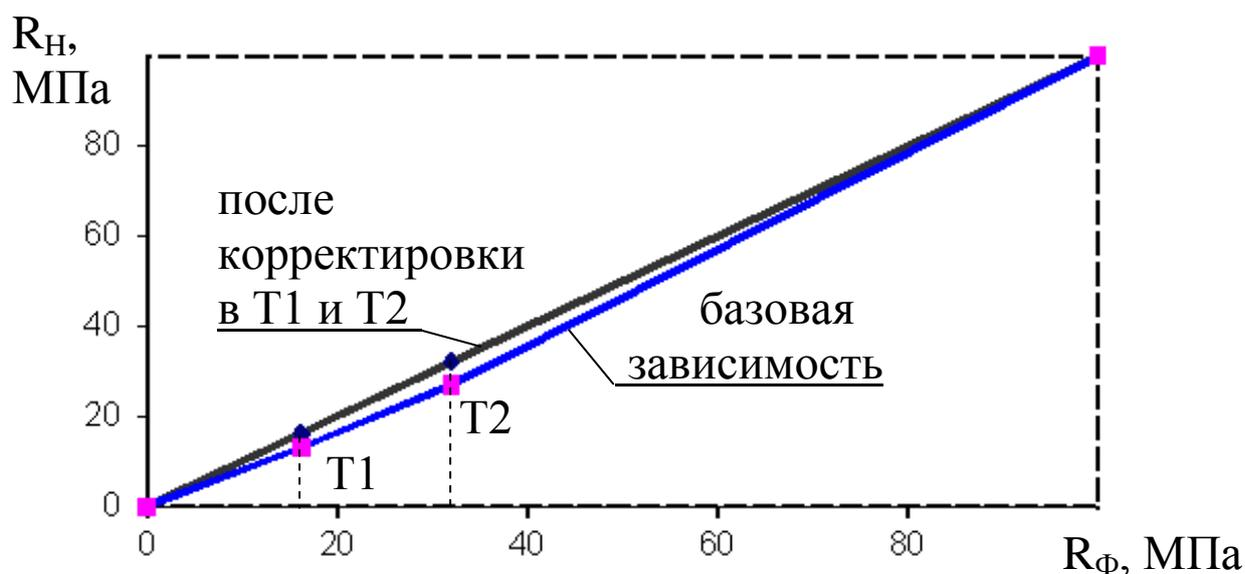
Измеритель позволяет произвести корректировку базовой зависимости при количестве точек корректировки от 1 до 9 в диапазоне от 3 до 80 МПа.
