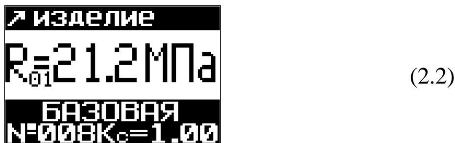
2.2.2.2 Цикл измерений на одном участке состоит из десяти, пятнадцати измерений (по усмотрению оператора). По окончании цикла из пятнадцати измерений происходит автоматическая обработка результатов, и на дисплее отображается среднее арифметическое значение прочности из пятнадцати единичных результатов, например:
