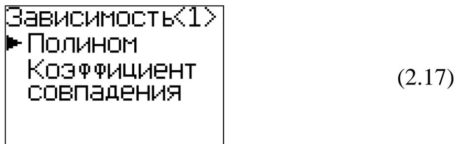
В измерителе предусмотрена возможность ввода индивидуальной зависимости путем корректировки базовой зависимости коэффициентом совпадения ( $K_C$ ), либо путем ввода коэффициентов полинома ( $a_0...a_4$ ).
